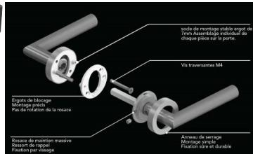
Poignée avec rosace carrée à trois pièces avec ressort de rappel. Fixation par vis traversantes M4, avec ergots de fixation. Ensemble comprenant deux bâquilles et deux rosaces.
