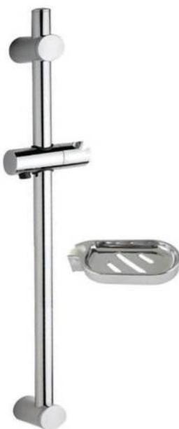
Barre de douche inox rénovation, diamètre 18mm. Supports ABS chromé. Longueur 60cm, entraxe variable de 30 à 50cm évitant un nouveau perçage. Coulisse ABS chromée pour flexible à écrou conique. Porte savon inclus.
