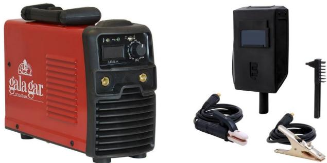
Poste onduleur pour la soudure en courant continu d'électrodes fourrés MMA et TIG DC. Technologie onduleur avec transistors IGBT. Pour une utilisation professionnelle avec électrodes 4mm. Soudure MMA à haut rendement. Soudure d'électrodes standard et électrodes basiques. Fonctions Hot Start, Arc Force et Anti-sticking. TIG DC, amorçage Lift-Arc. Affichage digital du courant de soudage choisi. Connecteurs de soudure 10/25mm.
