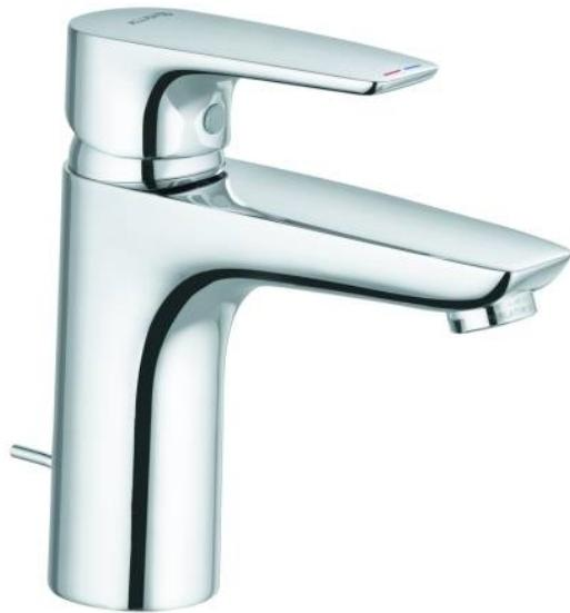
Mitigeur de lavabo 100 DN 15 montage monotrou. Levier plein. Cartouche céramique avec limiteur eau chaude. Régulateur jet M 24 x 1. Débit 7L/min à 3 bars. Garniture de vidage G 1 1/4". Raccords flexibles G 3/8". Système de montage rapide.
