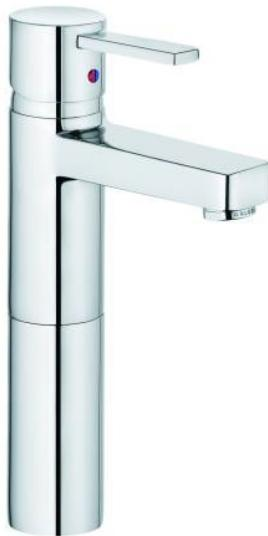
Mitigeur pour lavabo-vasqueDN 10. Levier plein. Montage monotrou. Débit classe Z. Mousseur s-pointer éco M 24 x 1. Cartouche céramique avec limiteur eau chaude. Sans garniture de vidage. Système de montage rapide. Raccords flexibles G 3/8". Classe acoustique I. Hauteur de bec verseur225mm.
