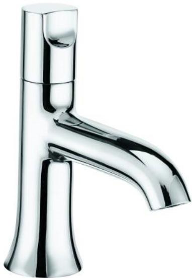
Robinet de lavabo DN 15. Manette cylindrique. Montage monotrou. Débit classe Z. Mousseur s-pointer éco M 18,5 x l. Tête céramique 90°. Sans garniture de vidage. Catégorie de bruit I. Livré sans raccord flexible.
