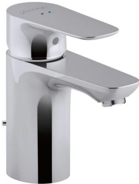
Mitigeur monotrou avec vidage. Débit 5L/mn (sous 3 bars). Hauteur totale 142mm, saillie du bec 98mm. Avec flexibles d'alimentation. Cartouche à disques céramique.
