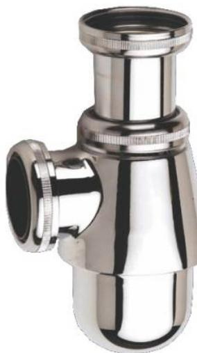
Siphon bouteille en laiton faible encombrement, réglable en hauteur. Hauteur réglable de 100 à 150mm. Raccordement d'entrée G1"1/4. Raccordement de sortie ø32mm. Garde d'eau 35mm. Débit 40L/min sous une charge d'eau de 120mm.
