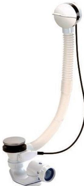
Vidage automatique de baignoire à câble chromé. Bonde avec commande du clapet par câble. Siphon bi-matière. Vidage polypropylène. Volant et clapet en ABS chromé. Bonde 52mm. Raccordement à l'évacuation 40mm.
