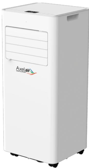
Jaquette en ABS. Réfrigérant R290. 3 débits d'air. 4 fonctions : auto - froid - ventilation - déshumidification. Évacuation automatique des condensats. Programmateur horaire et fonction sleep (réduction progressive en mode nuit). 4 filtres à air anti-poussière lavable et 1 filtre au charbon actif. Bac de condensats anti-bactérien. Alimentation 230 VAC. Classe d'isolation II. Température de fonctionnement de 18 à 35°C. Evacuation de l'air chaud grâce au tuyau extérieur fourni.
