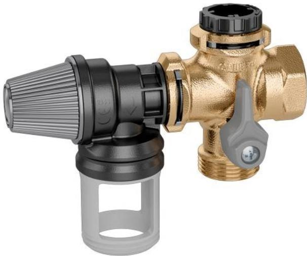
Groupe de sécurité multiposition pour chauffe eau à accumulation d'une puissance maxi de 10kW. Equipé d'un clapet anti-retour d'une vanne d'isolement et d'une soupape tarée à 7 bar, conforme à la norme française EN1487. Siège en polymère ultra résistant évitant les risques de collage, de corrosion et d'incrustation de calcaire. Particulièrement adapté pour les eaux calcaires et agressives.
