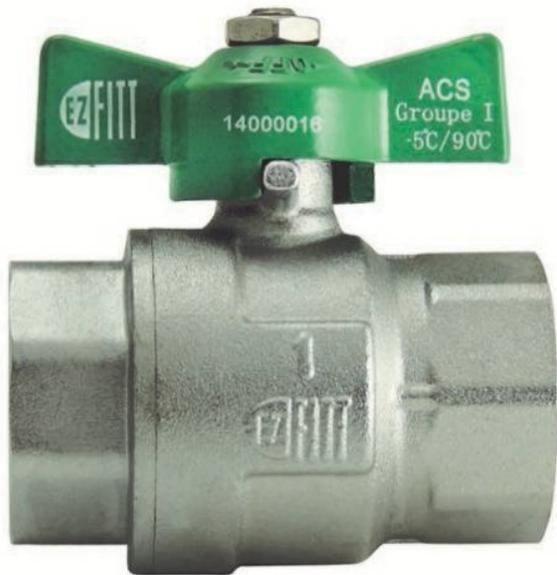
Vanne à boisseau sphérique en laiton matricé CW617N (norme européenne), revêtement 100% chromé. Conception, fabrication et contrôle suivant la norme NF079. Passage intégral. Température de 110°C en pointe (-5°C à +90°C en continu). Raccordement ISO 228-1. Etanchéité par double joint torique EPDM. Axe injectable. Poignée en alu + écrou en inox (anti-corrosion). ACS.
