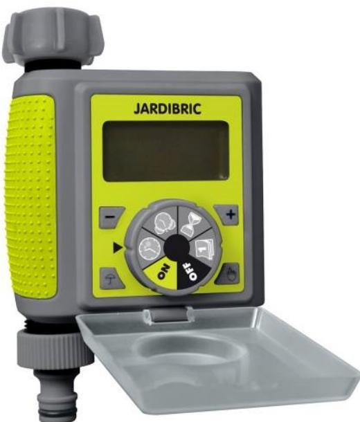
Programmateur/temporisateur nez de robinet à affichage digital. Brumisation, aspersion, goutte à goutte, programmation de 5 secondes à 360 minutes toutes les 10 secondes à 7 jours. Entrée F 20x27mm (3/4") à écrou tournant. Sortie filetée M 20x27mm (3/4"). Ecran LCD. Couvercle de protection.
