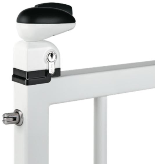
Serrure de haute qualité pour portillon de piscine avec mécanisme en acier inoxydable, coffre en polyamide et en aluminium thermolaqué. Cette serrure est conforme à la norme NF P90-306. Le Twist nécessite deux actions simultanées pour libérer la serrure ce qui évite l'accès des enfants à la piscine. L'unique pêne à roulette facilite la fermeture de la porte. Profil carré 40mm.
