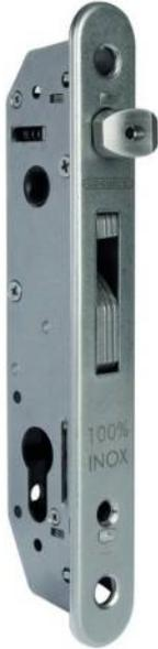
Serrure à encastrer avec mécanisme 100% en acier inoxydable. Le réglage du pêne demi-tour et la combinaison du crochet inoxydable avec la gâche anti-écartement permet une fermeture sûre et sécuritaire de votre portail. Cette serrure peut être utilisée dans l'acier, l'aluminium et le PVC. Avec son système breveté "Click-It" la serrure est montée en quelques secondes.
