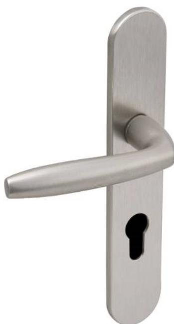
Ensemble monobloc : bâcheille et plaque solidarisées. Plaque renforcée avec sous-plaque en polyamide chargé à 60% en fibre de verre. Plaque renforcée avec sous-plaque en zamak chromé côté extérieur. Poignée de tirage réversible. Entraxe 195mm.
