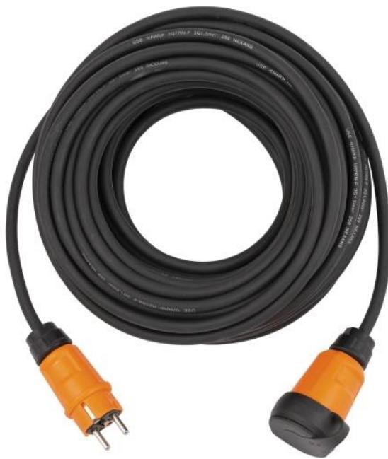
Pour une utilisation sur les chantiers et en extérieur (IP44). Avec fiche très robuste et prolongateur avec clapet. Fiche et prolongateur de type droit 2P+T 16A/230V. Résistant aux ultra-violets et aux torsions, avec joint d'étanchéité. Câble très robuste, résistant aux hydrocarbures. Adapté à un usage professionnel. Norme NF C 61314:2008/A1:2010.
