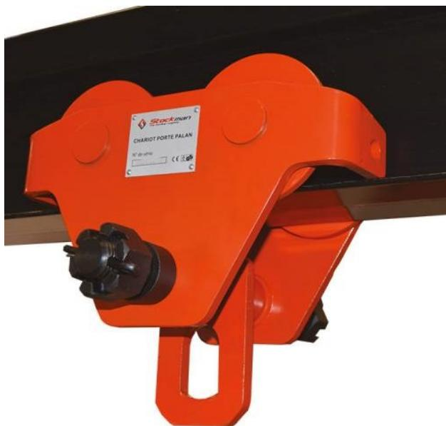
Chariot porte palan manuel équipé de 4 galets montés sur roulements à billes. Le réglage de l'écartement se fait par empilage de rondelles et la translation par poussée.
