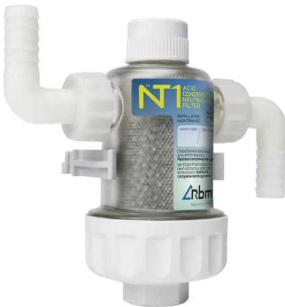
Filtre neutralisant de condensat acide pour chaudières à condensation. Combat la corrosion due au condensat acide. Résistant aux agents chimiques dissous dans la vapeur d'eau qui se condense dans la chaudière. Évent atmosphérique selon la norme UNI 7129-05. Entretien facile et rapide. Extrêmement compact.
