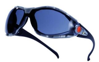
Lunette de protection monobloc en polycarbonate. Pont nasal polycarbonate intégré. Branches nylon inclinables pour un ajustement parfait à la forme du visage. Protections latérales. Protection mousse en amoviblepour une très bonne étanchéité dans les environnementspoussiéreux et un confort accru en cas de choc. Monture nylon, oculaires polycarbonate.
