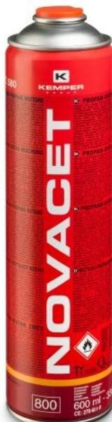
Cartouche de gaz à valve avec pas de vis universel ( 7/16"). Conforme à la norme EN417:2012. Soupape interne de sécurité. Cette cartouche contient un mélange de gaz butane propane et des adjutants pour une meilleure performance (rapidité d'exécution et qualité de la brasure). Fonctionne même à des températures négatives. Cette cartouche est à utiliser avec les lampes à souder à valve.
