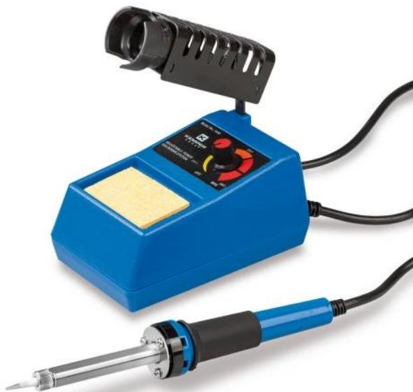
Station de soudage électronique avec support de fer, support et éponge de nettoyage de pane. Variateur de température 0 à 400°C. Livré avec une pane pointe de rechange de 5mm de diamètre. Dimensions 280x325x255mm. Poids 600g. Alimentation 230V.
