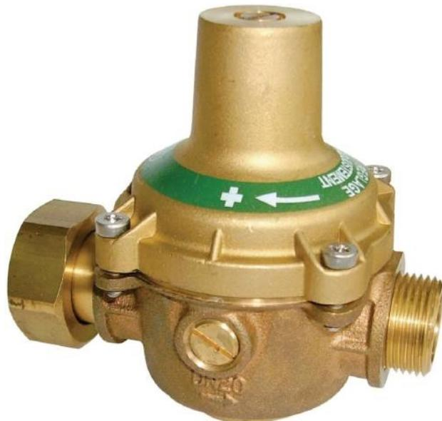
Réducteur de pression Desbordes Série 11 Bis M/F. Prise de pression 1/4" de chaque côté pour montage mano. Plage de réglage aval de 1 Bar à 5,5 Bar, livré pré réglé à 3 BAR. Pression maxi 25 bars, température maxi 80°C. Raccord mâle et femelle écrou tournant.
