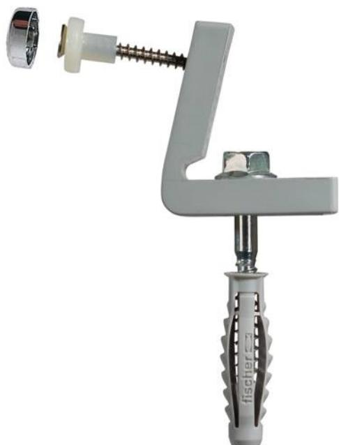
Kit de fixation complet pour WC au sol et bidets avec chevilles, vis et capuchons. Les rangées de trous de l'équerre de montage WB5 N permettent une fixation flexible dans deux directions et compensent les différences de hauteur des céramiques.
