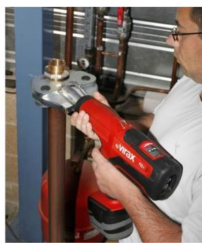
Adaptables sur toutes les machines disponibles sur le marché. Dureté 20 % supérieure à celle des pinces classiques Acier très haute résistance (33 HRC). Essais de résistance réalisés avec une pression comprise entre 12T et 15T exercée 10 000 fois.
