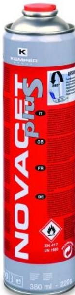
Cartouche de gaz à valve avec pas de vis universel (7/16") et soupape interne de sécurité. Conforme à la norme EN417:2012. Contient un mélange de gaz butane/propane et des adjuvants pour une meilleure performance (rapidité d'exécution et qualité de la brasure). Fonctionnement même à des températures négatives. Cette cartouche est utilisée pour les lampes à souder à valve. Fonctionnement en toutes positions grâce à la mousse placée à l'intérieur de la cartouche. Dimensions : 5x13cm.
