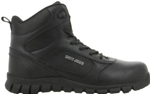
Chaussure en cuir et nylon, doublure en technomesh respirant, antistatique, antidérapante, semelle anti-perforation textile en aramide légère 1100N, antichoc, embout nano carbone 200J, semelle Phylon et caoutchouc naturel, antidérapant, résistant à l'abrasion et aux huiles minérales et acides faibles.
