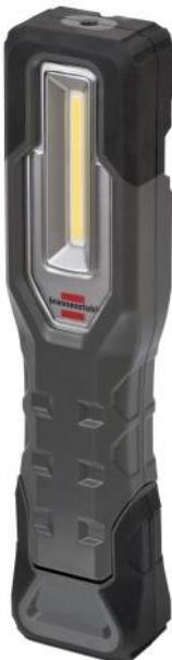
LED COB très claire en façade. Mode d'éclairage supplémentaire par la LED SMD en frontal. Fonction dimmable en continu de 10% à 100% pour une durée d'éclairage particulièrement longue. Revêtement en caoutchouc pour une résistance accrue aux impacts et une meilleure adhérence. Socle de maintien orientable jusqu'à +/- 60° avec aimant intégré. 2 aimants au dos et 1 crochet escamotable pour une utilisation facile. Batterie Li-Ion 3,7 V/4,4 Ah intégrée avec témoin de charge. Chargement par prise USB.
