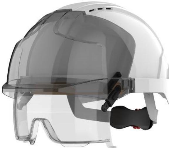
Casque avec lunettes intégrées. Calotte ABS (Acrylonitrile Butadiène Styrene). Harnais : serrage et araignée en LDPE (polyéthylène basse densité) & polyester. Oculaire en Polycarbonate/TPE. Bras sur-lunette nylon. Marquage oculaire EN166 2C-1.2 1 FT K N.
