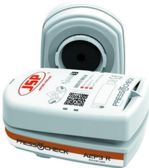
Offre un facteur de protection assignée (FPA) de 10 fois la valeur limite d'exposition (VLE) contre les poussières fines, fibres, fumées et aérosols liquides lorsque fixée sur un demi masque Force 8. Extérieur de la cartouche en ABS, intérieur charbon actif et matériaux synthétiques.
