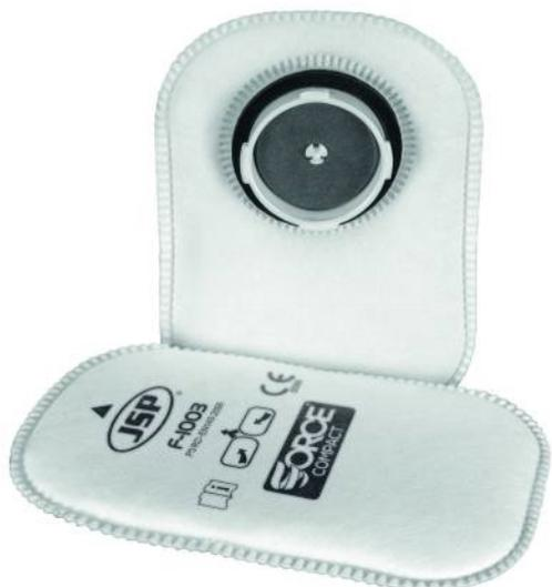
Montés sur un masque Force 8 les filtres offrent un facteur de protection assignée (FPA) de 20x la valeur limite d'exposition (VLE) contre les poussières fines, fibres, fumées et aérosols. Filtre extérieur en fibres synthétiques, cadre du filtre en ABS, média filtrant en fibres synthétiques.
