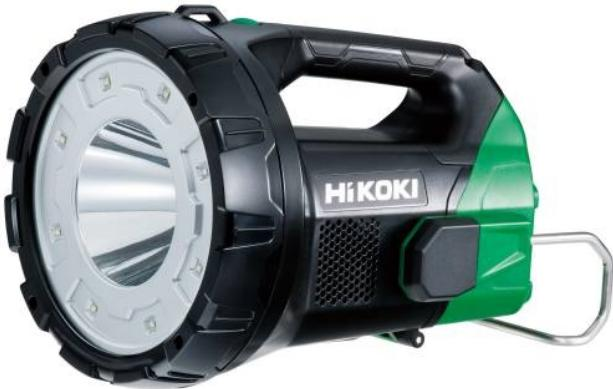
Lampe longue portée pour l'éclairage de tous types de chantiers. Norme IP54. Résistance Eau et poussière. Jusqu'à 18H20 d'autonomie en mode éco avec la batterie BSL1850. Crochet réglable pour la suspension de la lampe sur chantier. Un trépied peut être fixé à l'aide d'une vis W5/8 pouces située sur le dessous de la lampe (accessoire fourni). Accepte toutes les batteries à glissière 14,4V, 18V et MultiVolt.
