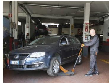
Cric rouleur hydraulique. Pédale d'approche rapide. Structure en acier et roues en nylon. Hauteur min./max. : 75/500mm.
