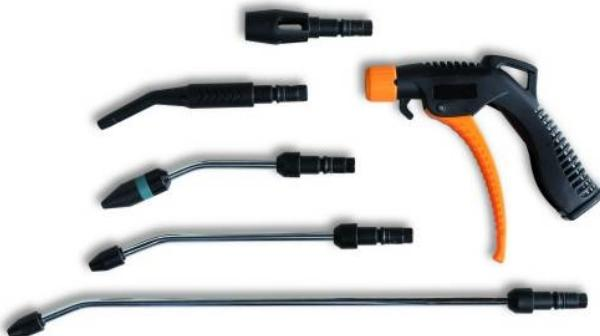
Soufflette progressive avec 5 buses (3 buses en acier 10/16/32cm avec embout de protection en caoutchouc anti-rayures, 1 buse "Turbo" en nylon renforcé avec fibres de verre et embout de sécurité et 1 buse orientable 10cm nylon renforcé avec fibres de verre). Doté d'un système de fixation rapide. Corps en matériau composite à haute résistance, antichoc. Embout cuivre fileté 1/4" GAS. Consommation d'air moyenne 280L/min.
