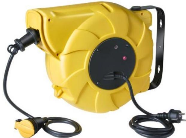
Enrouleur électrique automatique 20m+1,5m de câble H07RN-F 3G1,5 avec un disjoncteur thermique (IP44, montage mural, pivotant). Puissance maximum : câble non déroulé 1000W et câble déroulé 2300W. Boîtier robuste en polypropylène et disposant d'un ressort à spirale muni d'un dispositif d'arrêt. Contacts par frottements très performants.
