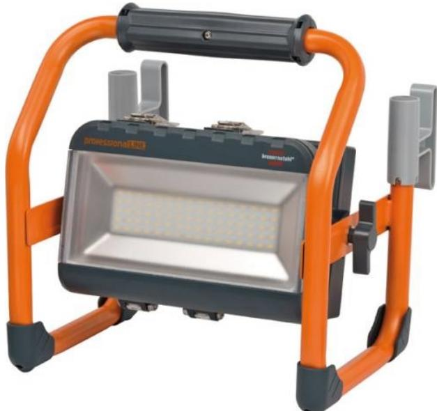
Projecteur LED SMD rechargeable avec batterie 3200 lumens (40W, IP55, 2 modes d'éclairage), garantie 3 ans. Autonomie : 2,5h (100%), 5h (50%) sur batterie 18V 5 Ah
