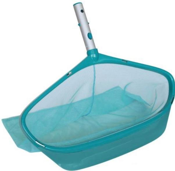
Epuiette de fond pour ramasser les feuilles et saletés au fond de la piscine. Large raclette à l'avant (5 cm de large). Inclinaison à 40°. Filet souple et robuste en polypropylène. Armature en aluminium. Bords incurvés. Bouton presseoir, compatible avec tous les manches télescopiques Bayrol.
