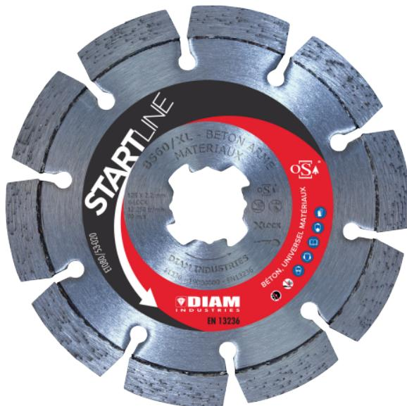
Très performant sur les coupes à sec et à eau des matériaux de maçonnerie. Coupe de béton, brique, parpaings, béton armé et pierre de bordure. Sa bonne tenue satisfera les besoins classiques de sciage BTP. Alésage X-Lock pour fixation en un clic sur meuleuse d'angle. Pour découpeuse, scie à sol et meuleuse.
