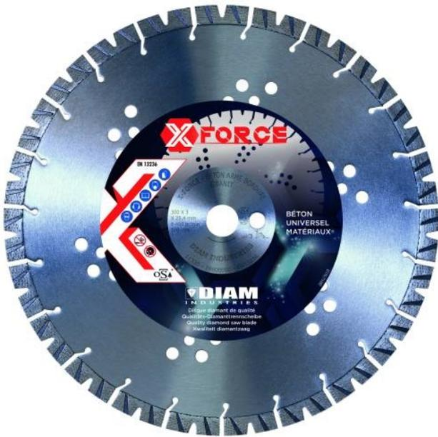
Le disque diamant à grains alignés. Segments à grains diamant alignés hauteur 15mm : pression et usure uniforme des grains. Durée de vie prolongée, performances de coupe optimisées. Résistant pour la coupe de matériaux durs. Coupe béton, granit et pierre de bordure. Tôle perforée pour un meilleur refroidissement. Pour découpeuse, meuleuse et scie à sol.
