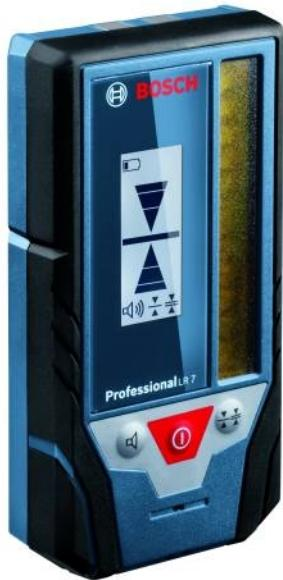
Permet de détecter les lignes laser vertes et rouges. Zone de réception de 8 m pour une détection rapide de la ligne laser. Signal d'alignement optique (écran et LED) et sonore, pour travailler dans toutes les conditions de visibilité. La cellule LR 7 est compatible avec le GCL 2-50 (C et CG) et le GLL 3-80 (C et CG).
