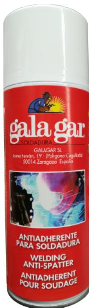
Anti-projections sans silicone pour le soudage des métaux. Il est utilisé comme anti-adhérent sur les pièces à souder et comme protecteur pour la buse de la torche. Grâce à sa formule sans silicone, il peut être verni, métallisé, chromé. Facilite et accélère le soudage en empêchant l'adhérence des étincelles soudure.
