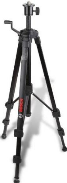
Le BT 150 est optimisé pour une utilisation avec les lasers croix et les lasers points. Le BT 150 peut être utilisé sur n'importe quelles surfaces grâce à sa robustesse apportant une grande stabilité. Tête pivotante pour orienter et incliner le laser lignes. Niveau à bulle. Filetage 1/4". Réglable en hauteur jusqu'à 1m57.
