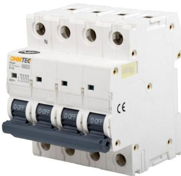
Disjoncteur à vis tétrapolaire NF. Pouvoir de coupure assignée 4500 A. Tension assignée 400 V - 50 HZ. Caractéristique : Montage sur rail DIN 4 modules, Normes EN 60898-1.
