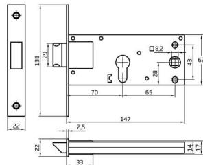
Serrure à mortaiser pour portes de menuiserie métallique. Conçue avec une façade en acier inoxydable et une entrée de 70 mm. Elle dispose d'un carré pour les poignées de porte et de trous pour l'installation de poignées de rossette avec des boulons traversants.
