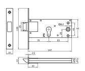
Serrure à mortaiser pour portes de menuiserie métallique. Conçue avec une façade en acier inoxydable et une entrée de 70 mm. Elle dispose d'un carré pour les poignées de porte et de trous pour l'installation de poignées de rosette avec des boulons traversants.
