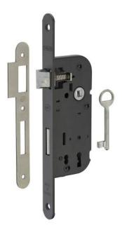
Coffre acier pour porte d'intérieur. Bord rond. Têtière acier. Demi-tour alliage réversiblesans démontage du coffre. Pêne acier. Gâche plate acier. Mécanisme à 1 tour. Carré 7 mm. 1 clé - 6 variures. Garantie 10 ans.
