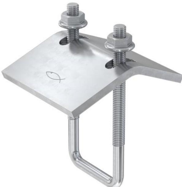
Le collier de serrage fischer TKR 31 convient pour la fixation de tubes et de canaux directement sur des poutres en acier. Le TKR 31 peut être fixé sur toutes les poutres en acier courantes grâce aux différentes longueurs des côtés de serrage. Aucun perçage ou soudure n'est nécessaire pour la fixation. Les colliers de serrage peuvent être démontés.
