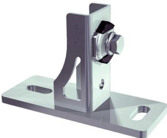
La bride de selle de l'élément de construction SF Clix 31 prémonté relie solidement les rails de montage FLS avec le support à un angle de 90°. L'élément prémonté permet d'économiser du temps et de l'argent. La fixation dans le SF Clix et la selle précise permettent une installation sûre et sûre. La plaque de base stable du SF Clix 90° avec des fentes à 90° facilite la fixation au substrat avec des chevilles ou des ancrages.
