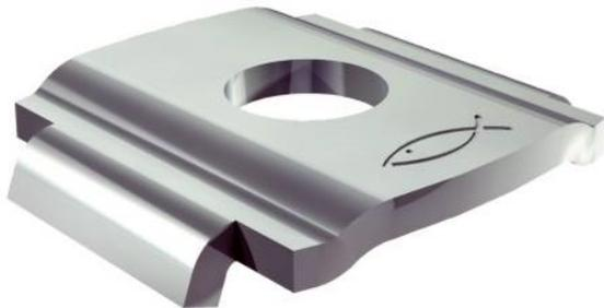
La rondelle de raccord HK 31 est équipée de pattes de fixation spéciales qui facilitent la réalisation d'un raccordement solide et positif, même dans le cas de rails suspendus. Les pattes de fixation permettent une installation facile dans le sens longitudinal et transversal par rapport au profilé de montage FLS. Ils permettent une installation simple et précise et permettent ainsi d'économiser du temps et de l'argent.
