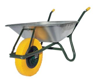
Cuve en tôle galvanisée 0,9mm. Châssis monobloc peint (tube 30x1,5mm). Pare-chocs et renfort du bac. Roue jaune increvable confort 400x100mm (confort d'une roue gonflée). Jante PP sur roulement à billes graissé.
