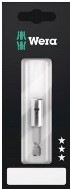
Porte-embouts universel pour l'admission d'embouts à emmanchement hexagonal 1/4" conformes à la norme DIN ISO 1173-C 6,3. Douille acier inoxydable pour une protection spécifique contre la corrosion. Hexagonal 1/4", convient pour visseuses à admission répondant à la norme DIN ISO 1173-F 6,3.
